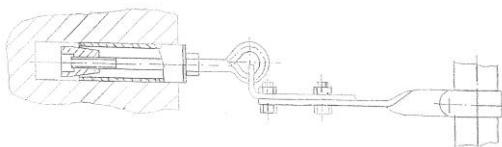
*Схема крепления лесов к стене*
