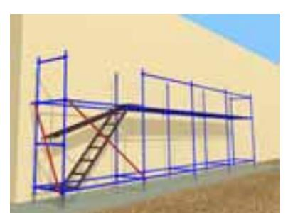
7. Установить стеновую опору между конструкцией и обрабатываемой поверхностью (см. Стеновая опора).
