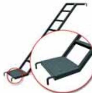
Лестница выполнена из стали 1,5мм и укреплена профильной трубой. На ступенях лестниц пробиты отверстия с пуклевкой, что обеспечивает безопасность работы на них. Лестница устанавливается по диагонали под углом 45° на высоту 2м и крюками крепится за поперечные горизонтали. Стальная лестница выдерживает нагрузку до 500кг.
