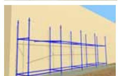
6. Для усиления жесткости конструкции закрепить диагональные элементы (см. Диагональный элемент).
